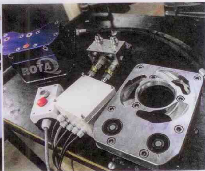
RotaQ bouwt de set zelf op. Dat duurt een uur of vier. Het elektrisch ventiele switcht tussen de vergrendelings- en normale extra functie. Met een kastje zit je hiertussen. Ter voorkoming van bedieningsfouten is een vertraging in car met een zoemer en lichtsignaal ingebouwd.
