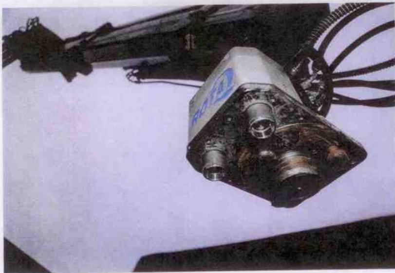
De RotaQ-snelkoppeling koppelt uitrustingsstukken automatisch. De dikke centreerpen valt in het gat van de tegenplaat. De rotator draait de koppeling een kwartslag, vast. De twee pennen links vergrendelen en koppelen de hydrauliekfunctie.
